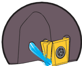
внутренняя подача СОЖ для обработки нержавеющей стали
