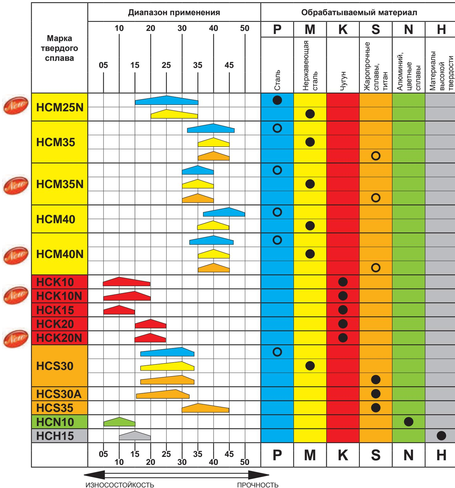
HC... - твердый сплав с износостойким покрытием
